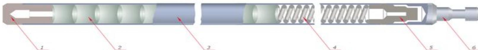
Устройство твэла реактора РБМК: 1 — заглушка; 2 — таблетки диоксида урана; 3 — оболочка из циркония; 4 — пружина; 5 — втулка; 6 — наконечник.
