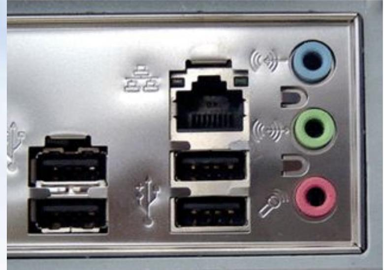
В этом случае гнездо для сетевого кабеля расположено на задней стенке системного блока.
