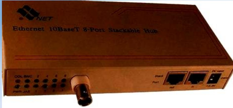
**Концентраторы (HUB или Switch)** - служат для соединения компьютеров в сети.
