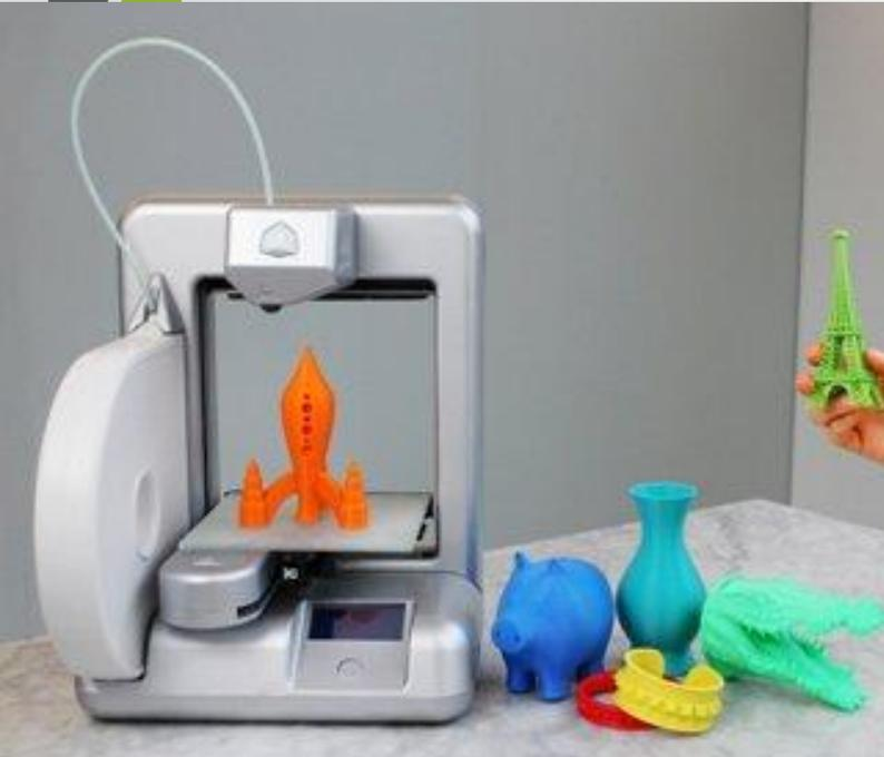
Сам процесс печати – это ряд повторяющихся циклов, связанных с созданием трёхмерных моделей, нанесением на рабочий стол (элеватор) принтера слоя расходных материалов, перемещением рабочего стола вниз на уровень готового слоя и удалением с поверхности стола отходов.
