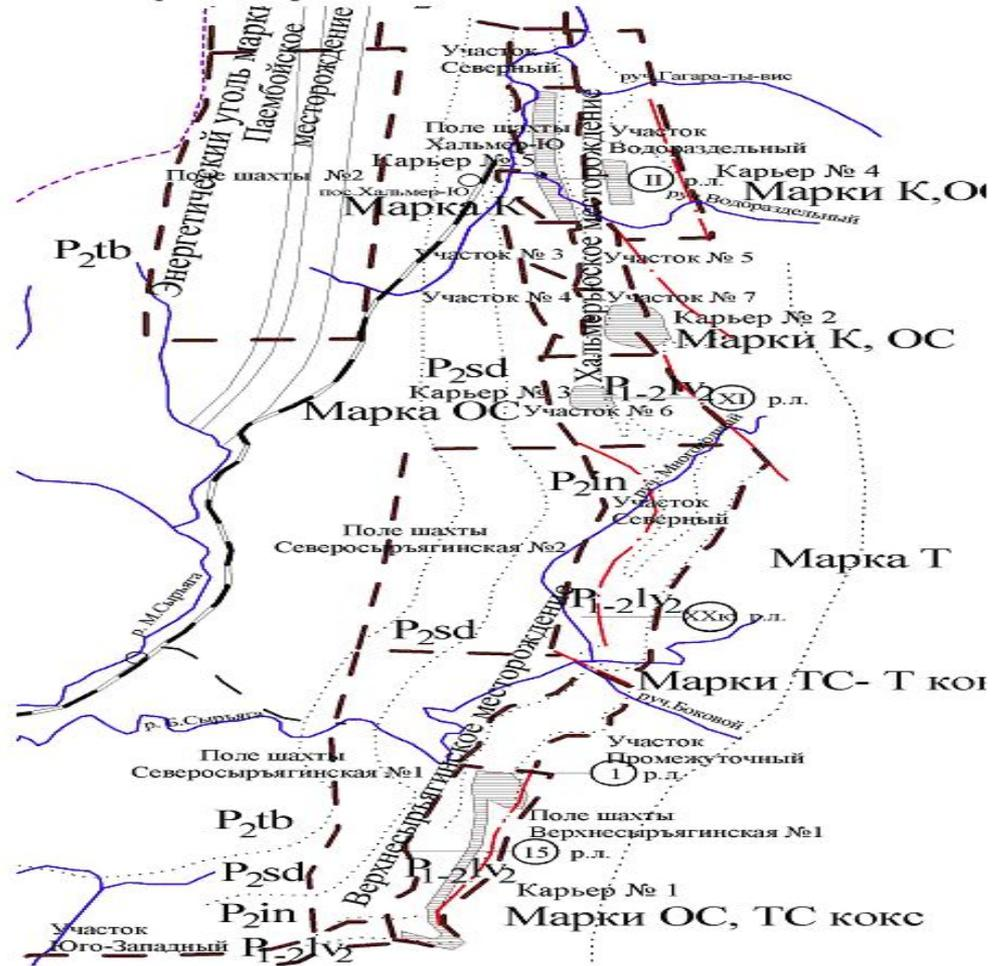
Схема участков для отработки карьерным способом
