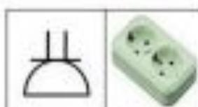
Штепсельная розетка открытой установки двухполюсная сдвоенная с защитным контактом (степень защиты IP20...IP23)
