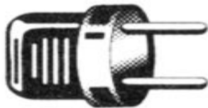
Трехполюсная вилка на 25А с заземляющим контактом
