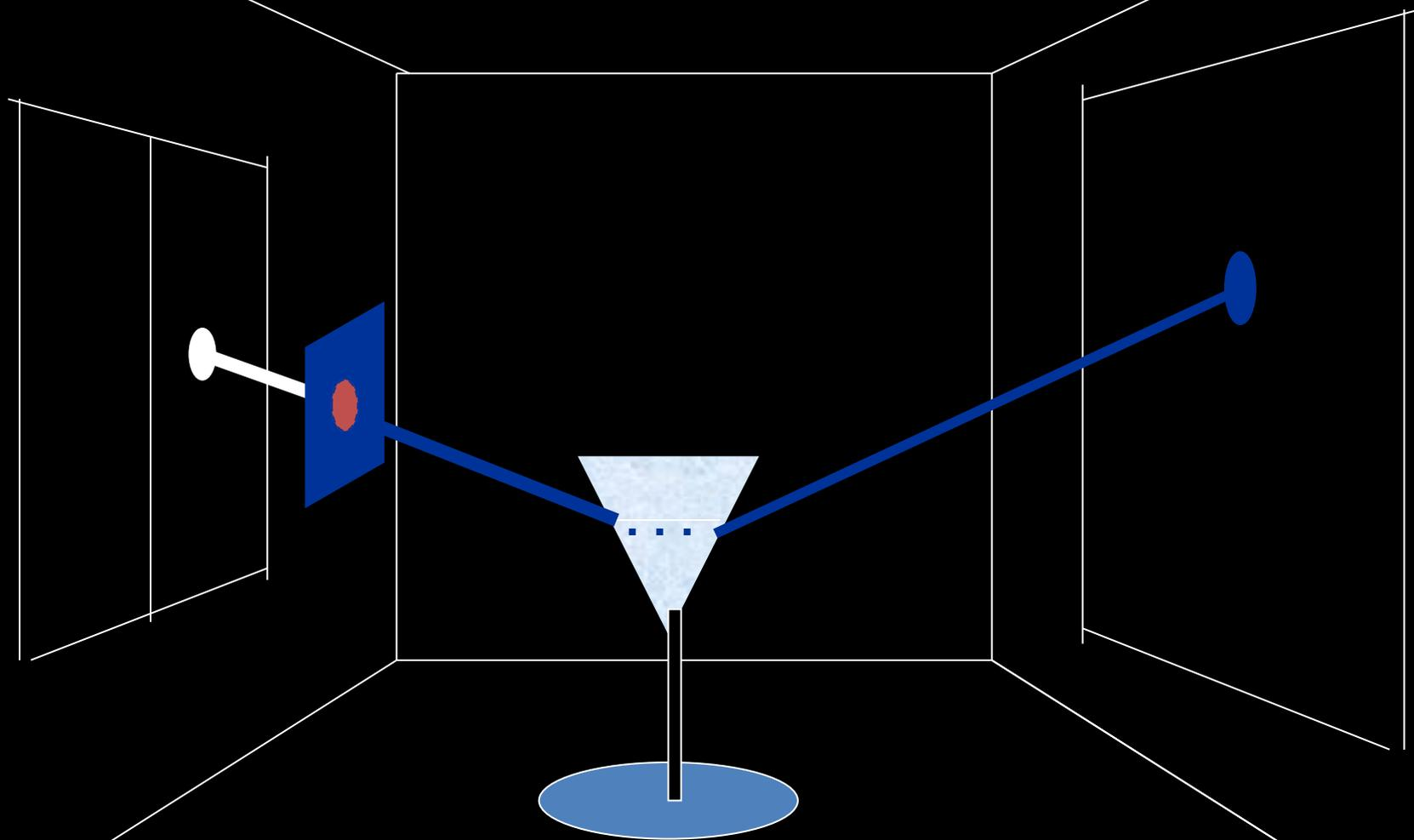
Закрив отверстие **синим** стеклом, Ньютон наблюдал на стене только **синее** пятно.
