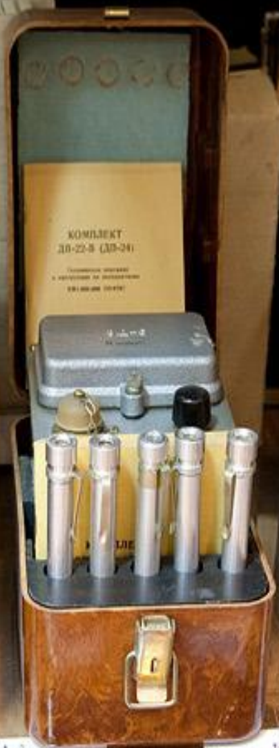
КАРМАННОЕ УВ. РАДИО СВЯЗИ ДВ-22 В Комплект для радиосвязи в условиях скрытого действия. 1942 г.
