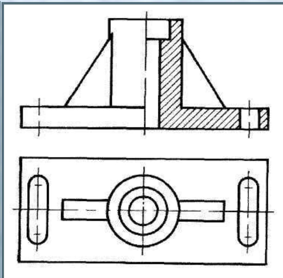
РАЗРЕЗ ВДОЛЬ ТОНКОЙ СТЕНКИ (РЕБРА ЖЁСТКОСТИ)
