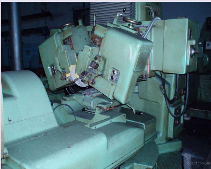
Рис. 31. Зубошлифовальный станок модели 5851
