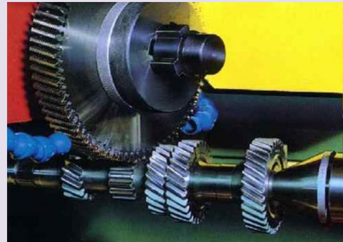
Рис. 24. Процессы шевингования: а – косозубого зубчатого колеса; б – много шестеренчатого вала
