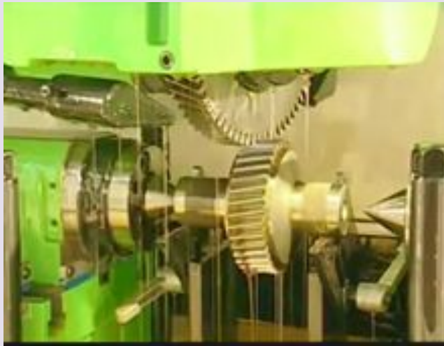
Рис. 24. Процессы шевингования: а – косозубого зубчатого колеса; б – много шестеренчатого вала
