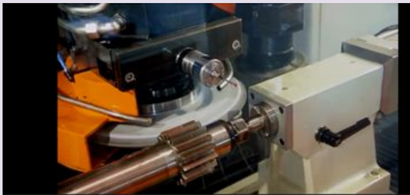
Рис. 26. Процессы обработки прямозубой и косозубой шестерен на станке SMG 405 Stanexim
