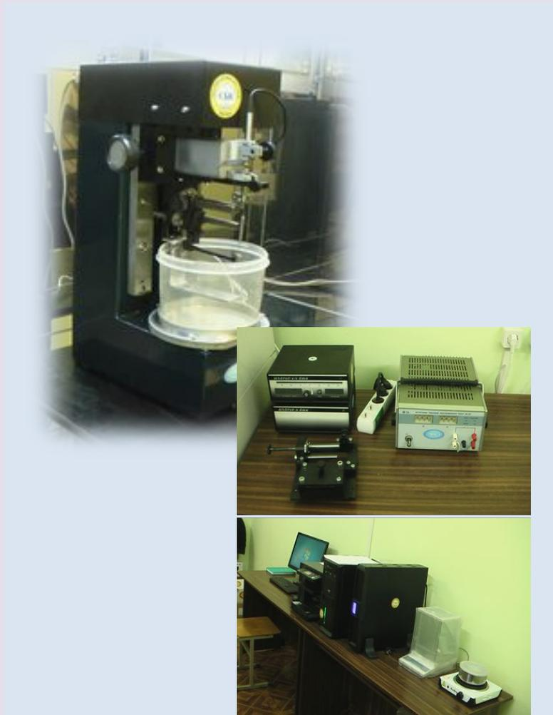
Рис. 50. Автоматизированная установка для определения остаточных напряжений
