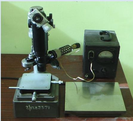
Рис. 48. Микротвердомер ПМТ-3
