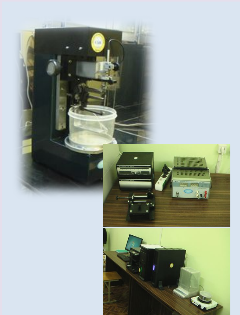
Рис. 50. Автоматизированная установка для определения остаточных напряжений
