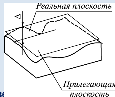
Рис. 36. Отклонение от плоскостности
