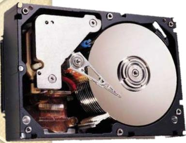
*Жесткий диск — устройство хранения информации произвольного доступа, основанное на принципе магнитной записи. Является основным накопителем данных в большинстве компьютеров.*
