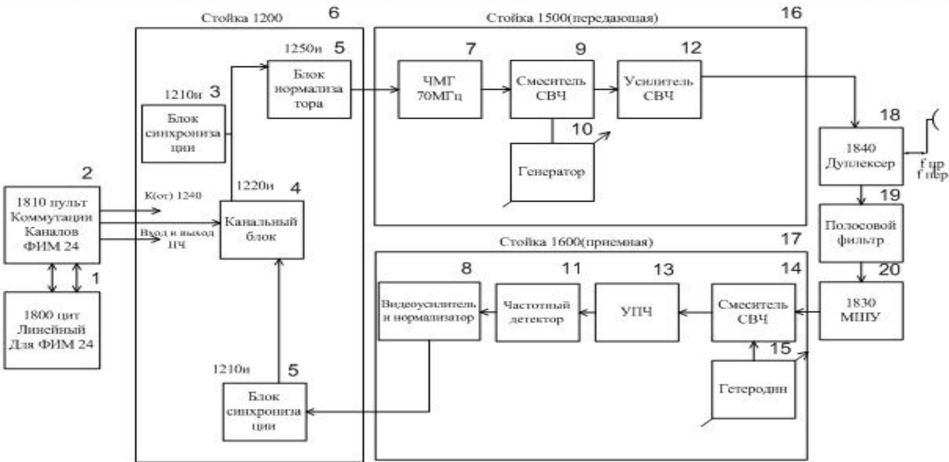
Рисунок – Структурная схема радиорелейной станции Р-414
