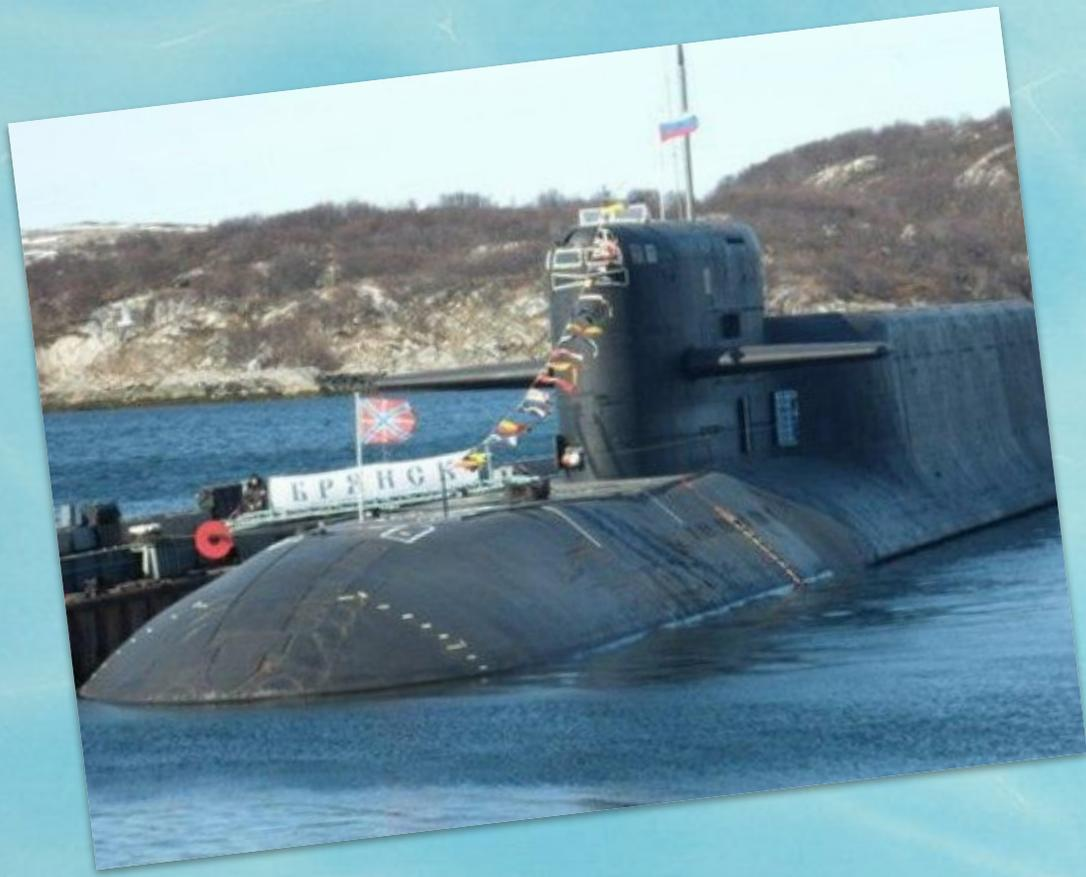
*К-117 «Брянск» — атомный ракетный подводный крейсер. Габариты крейсера поразительны: длина 170 метров, высота — пятиэтажный дом, на борту 16 баллистических ракет.*
