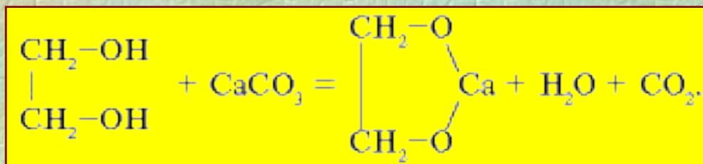
**Вследствие этой реакции содержание чистого этиленгликоля в растворе снижается, изменяются его характеристики. Существует и физическая причина: слой накипи на стенках системы охлаждения препятствует нормальному теплообмену и снижает эффективность охлаждения.**
