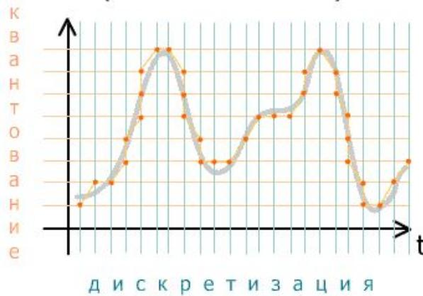
Кодирование сигнала в цифровой вид
