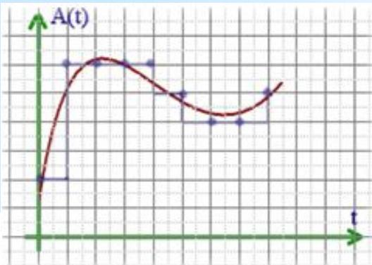
Звуковые сигналы в окружающем нас мире необычайно разнообразны. Сложные непрерывные сигналы можно с достаточной точностью представлять в виде суммы некоторого числа простейших синусоидальных колебаний. Причем каждое слагаемое, то есть каждая синусоида, может быть точно задана некоторым набором числовых параметров – амплитуды, фазы и частоты, которые можно рассматривать как код звука в некоторый момент времени.
