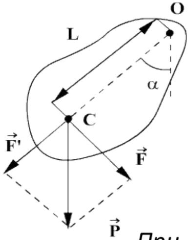
▣ **Физический маятник** - твердое тело, закрепленное на неподвижной горизонтальной оси (оси подвеса), не проходящей через центр тяжести, и совершающее колебания относительно этой оси под действием силы тяжести. В отличие от математического маятника массу такого тела нельзя считать точечной.
