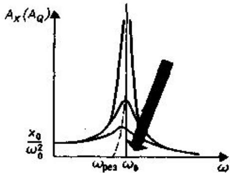
зависимость амплитуды вынужденных колебаний от частоты при различных значениях  $\delta$
