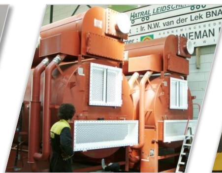
Покрытие теплообменников, охлаждаемых водой
