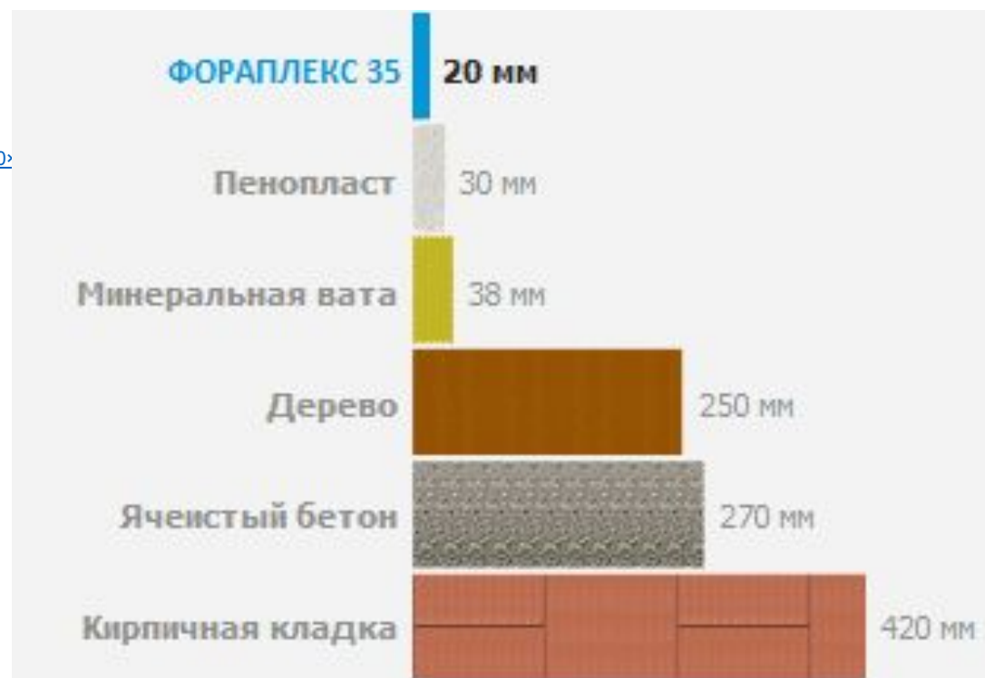
Сравнение толщин разных материалов при одинаковом сопротивлении теплопередачи
