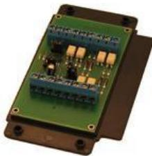
**Охранная панель** - предназначена для дублирования функций компьютера управления по отображению тревожных событий на посту охраны.
