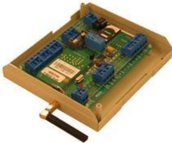
**ЭРА-8-GSM** является более совершенной версией контроллера ЭРА-4-GSM, применяется программное обеспечение с расширенными сервисными возможностями, такими как дифференцирование прав телефонов пользователей и применение разнообразных алгоритмов обработки событий на охранных шлейфах.
