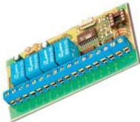
**Оптронная развязка** - выполняет гальваническое разделение сигналов управления между концентратором доступа и контроллером турникета (калитки, привода ворот).
