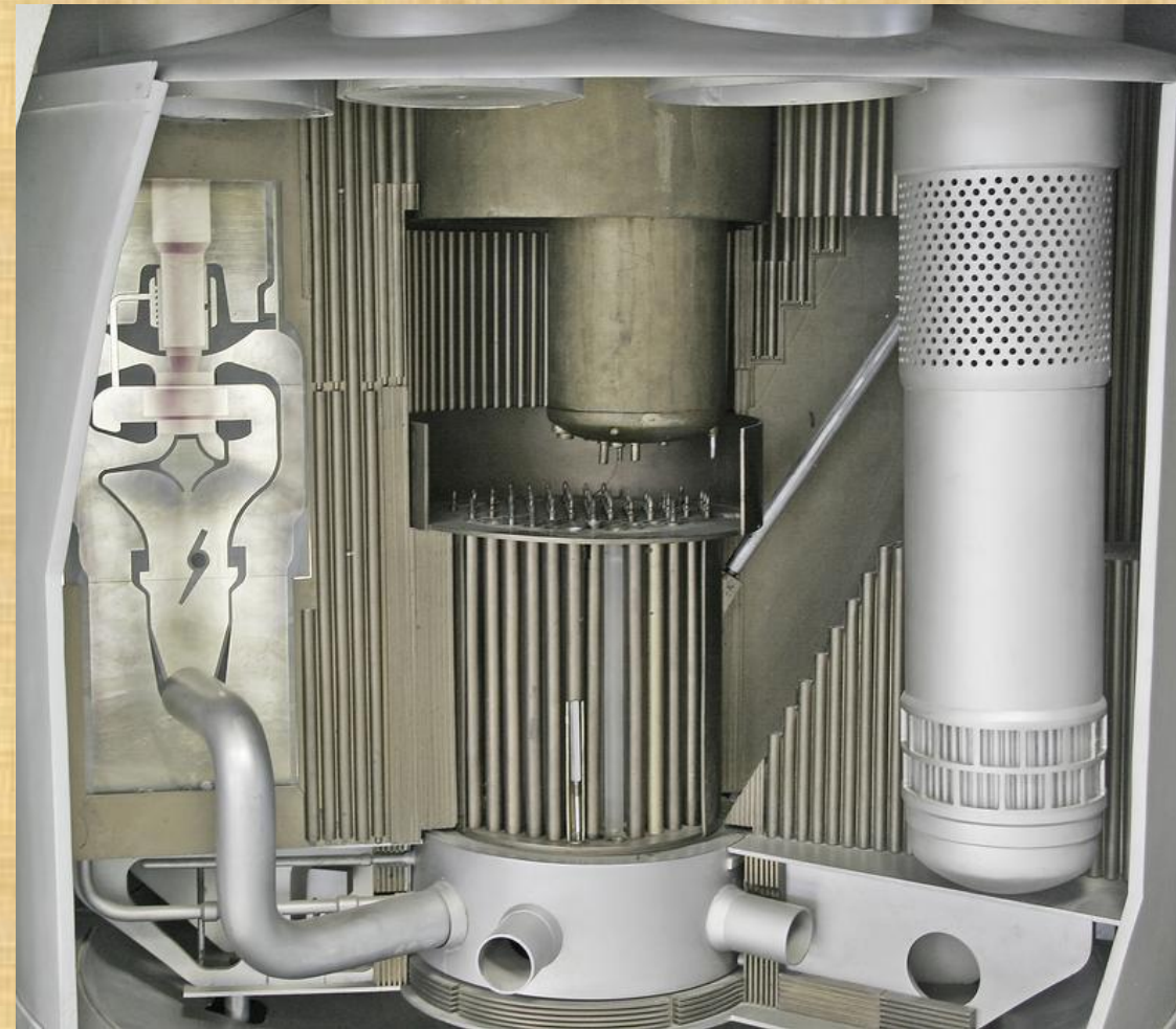
Схематическое устройство гетерогенного реактора на тепловых нейтронах
