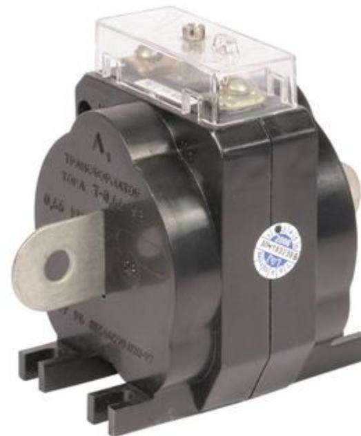
**Трансформаторы тока** предназначены для передачи сигнала измерительной информации измерительным приборам и применяются в схемах учета электроэнергии и схемах измерения в установках переменного **тока** частоты 50 Гц с номинальным.
