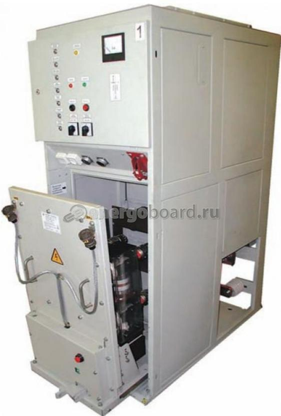
Комплектное распределительное устройство (КРУ) — распределительное устройство, собраное из типовых унифицированных блоков (т. н. ячеек) высокой степени готовности, собранных в заводских условиях. На напряжении до 35 кВ ячейки изготавливают в виде шкафов, соединяемых боковыми стенками в общий ряд. В таких шкафах элементы с напряжением до 1 кВ выполняют проводами в твердой изоляции, а элементы от 1 до 35 кВ — проводниками с воздушной изоляцией.
