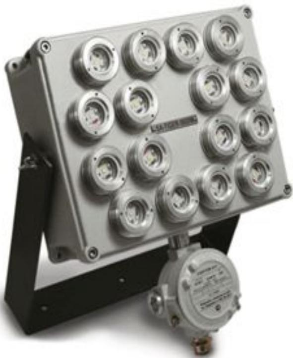
Светильник светодиодный сверхъяркий SA-TIGER-M Изделие состоит из корпуса, изготовленного из коррозионностойкого модифицированного алюминиево-кремниевого сплава, плафонов из ударопрочного поликарбоната и кабельных вводов с кабелем для подключения, длиной 5 метров 3x1,5мм<sup>2</sup>.
