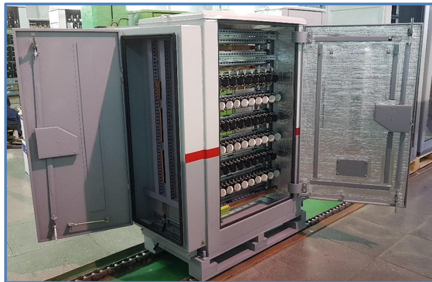
Шкаф ШУЗН модернизированный
