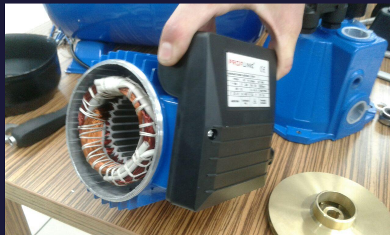
медная обмотка двигателя
