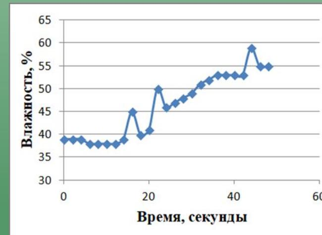
График зависимости влажности воздуха от времени – эксперимент №2
