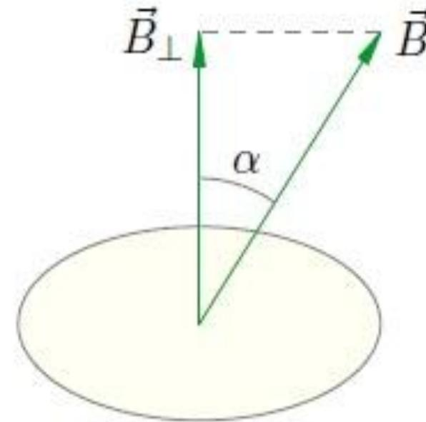
Понятие магнитного потока является характеристикой количества линий магнитного поля, пронизывающих контур.
