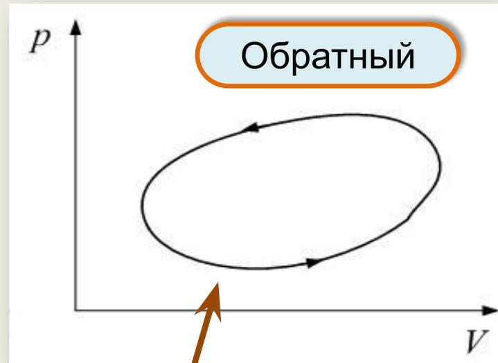
**Холодильная машина** отводит тепло от более холодного тела к более нагретому; при этом должна затрачиваться некоторая работа
