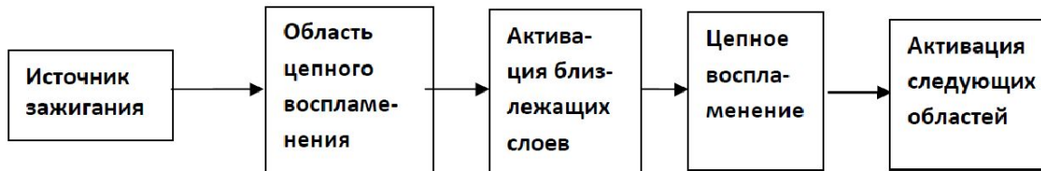
Рис. 2.6. Цепной механизм распространения пламени
