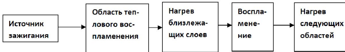
Рис. 2.5. Тепловой механизм распространения пламени
