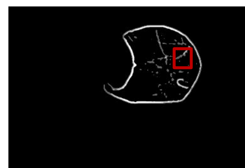
Определение краев с помощью регулировки сигмы оператора LOG
