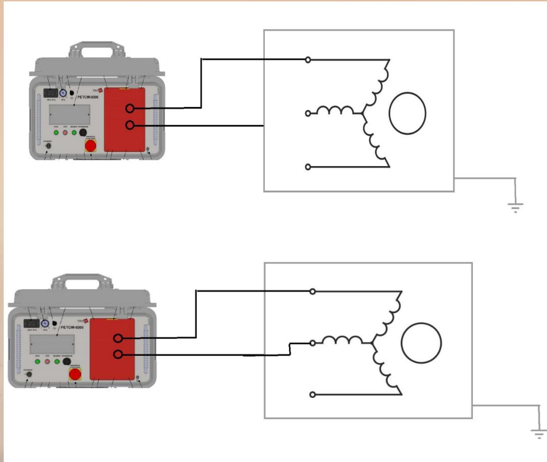
Проверка сопротивления изоляции и испытание перенапряжением
