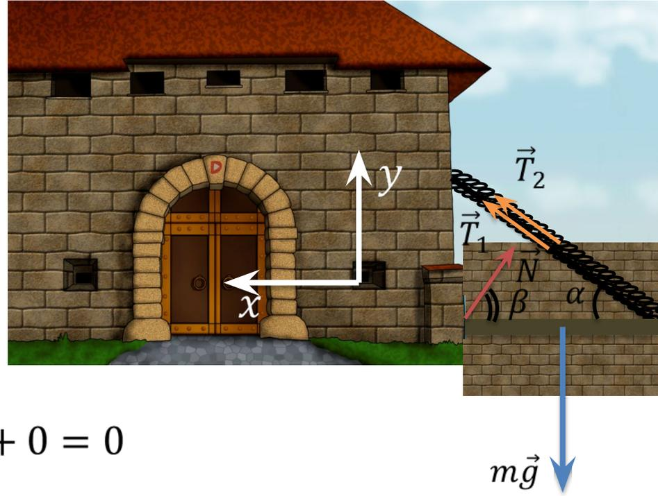
В некоторых замках использовались подъемные мосты. Предположим, что нагрузка распределяется равномерно между обеими цепями. Масса моста равна 2000 кг, а угол между цепью и мостом составляет  $40^\circ$ . Рассчитайте натяжение на цепях и силу реакции опоры.
