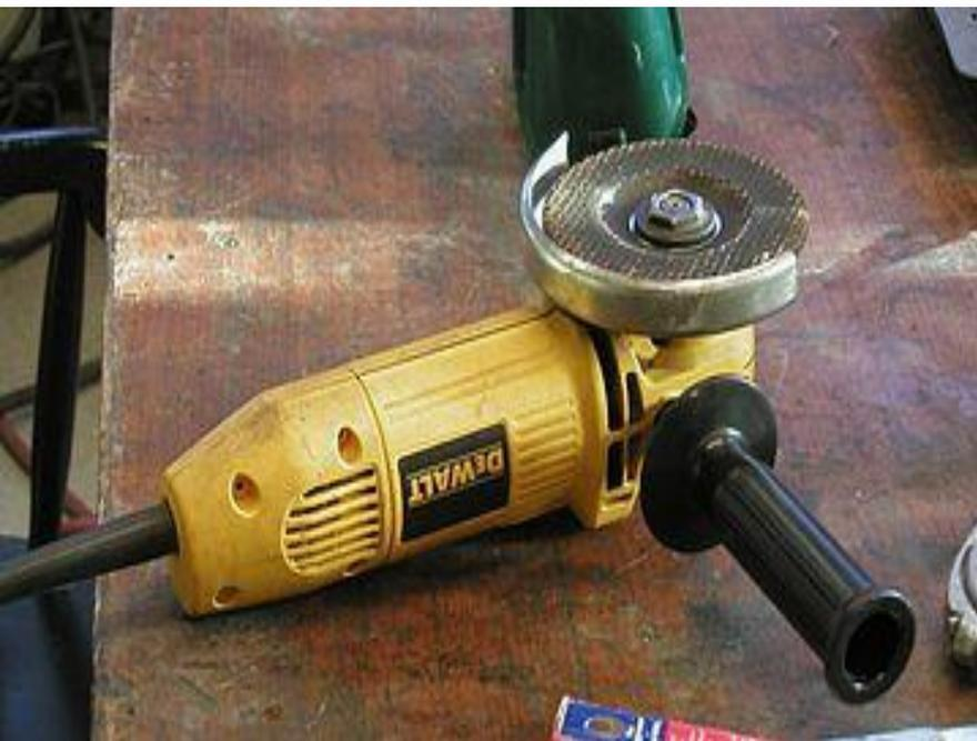
**Основное назначение - обработка стыков плоских металлических поверхностей. Так же она прекрасно подходит для резки листового металла и не только. Диски бывают: шлифовальный и отрезной.**
