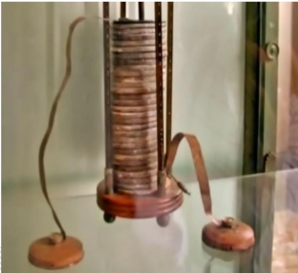
Такое расположение металлических и не металлических пластин давало электричество непрерывно и безотказно.
