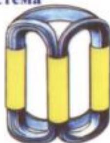
Пространственная стыковая магнитная система
