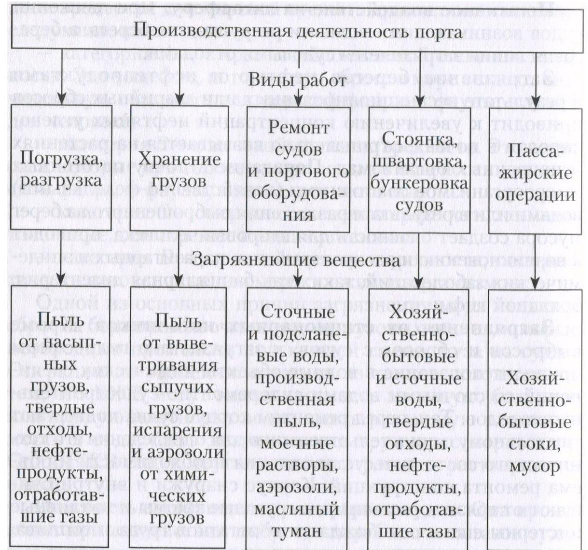
**Рис. 6.2. Загрязнение окружающей среды в ходе производственных процессов порта**
