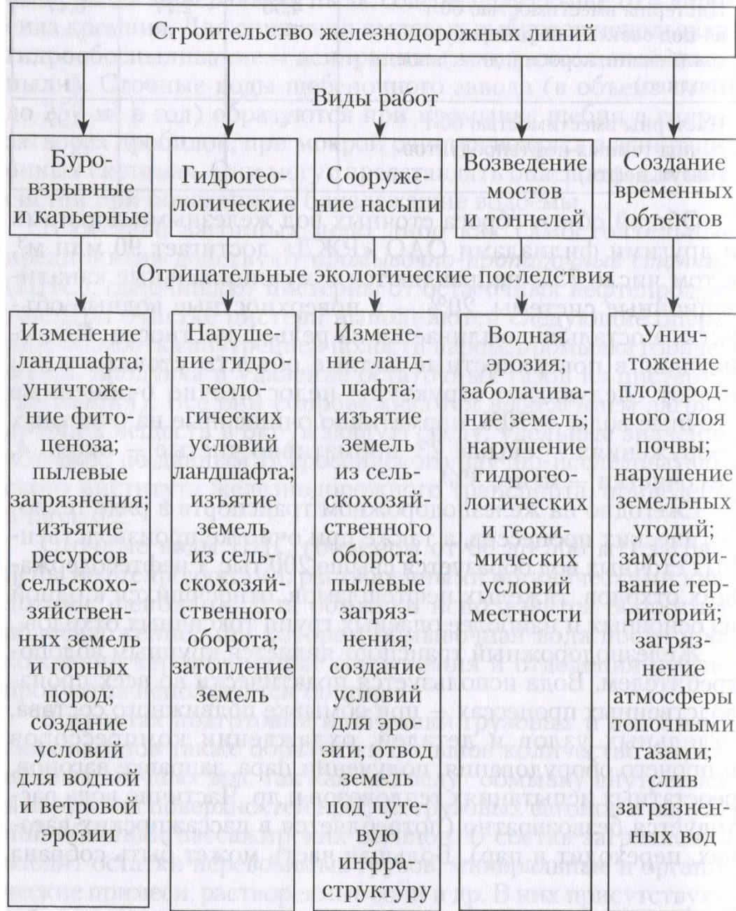
**Рис. 6.1. Объекты и характер воздействий на экосистемы при строительстве железнодорожных линий**
