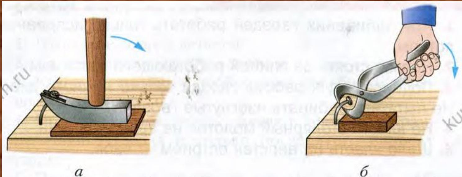
При забивании гвоздь может согнуться. В таком случае его необходимо вытащить с помощью молотка (*а*), имеющего специальную прорезь, или клещей (*б*).
