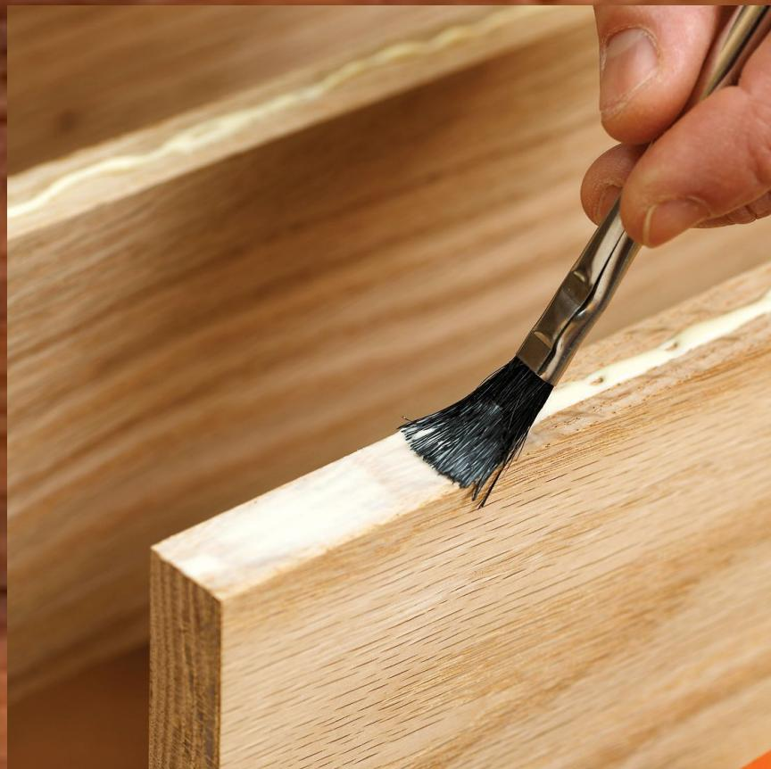
*Клей – это вязкое липкое вещество, которое наносится на склеиваемые поверхности и хорошо прилипает к ним. Плоскость соединения деталей на клею называют kleевым швом*
