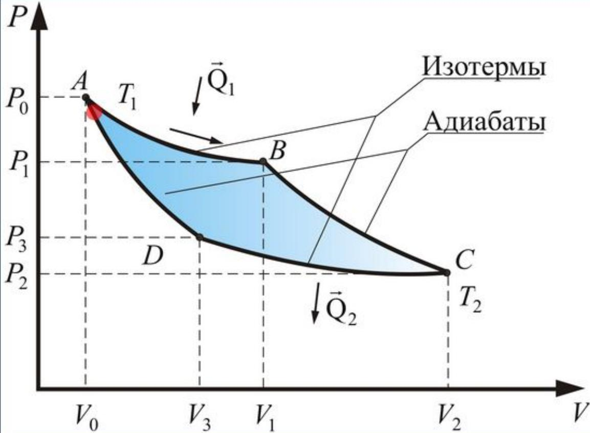
Адиабатическим расширением BC заканчивается первая половина цикла — совершение полезной работы.
