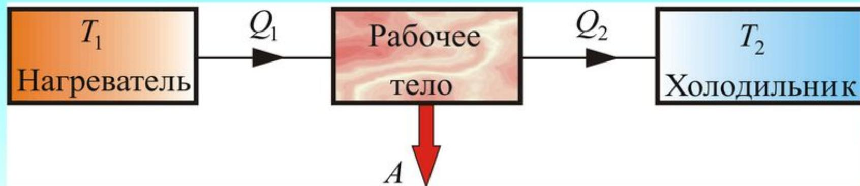
От термостата с более высокой температурой  $T_1$ , называемого *нагревателем* за цикл отнимается количество теплоты  $Q_1$ , а термостату с более низкой температурой  $T_2$ , называемому *холодильником* за цикл передается количество теплоты  $Q_2$  и совершается работа  $A = Q_1 - Q_2$ .
