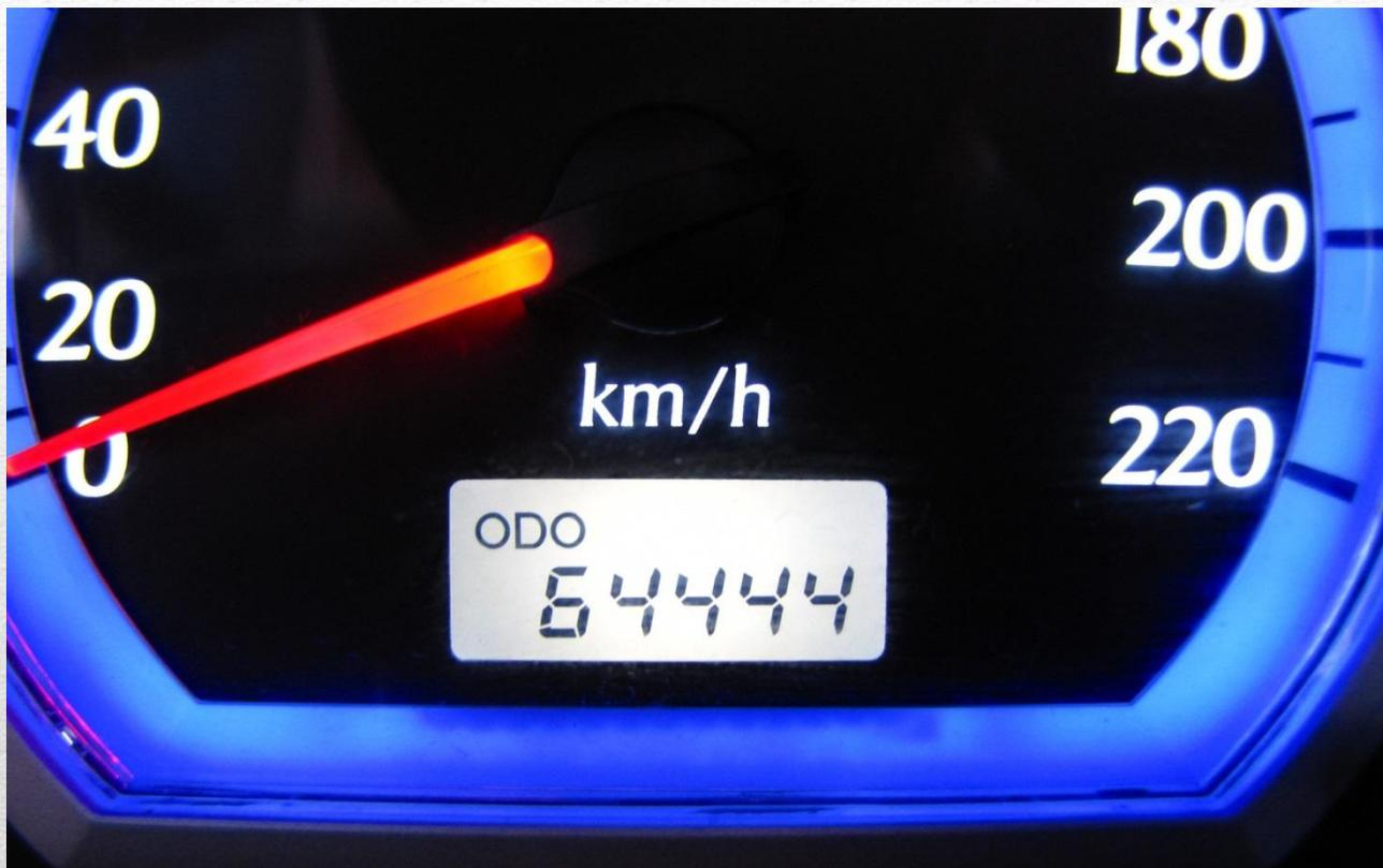
**Одо́метр** — прибор для измерения количества оборотов колеса. При помощи него может быть измерен пройденный транспортным средством путь. Первый одометр был изобретён Героном Александрийским.
