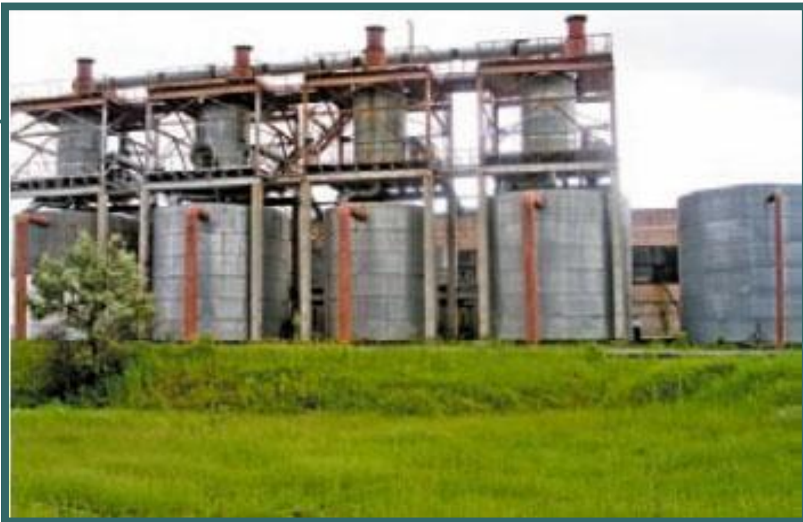
Насадочный декарбонизатор с кольцами рашига.
