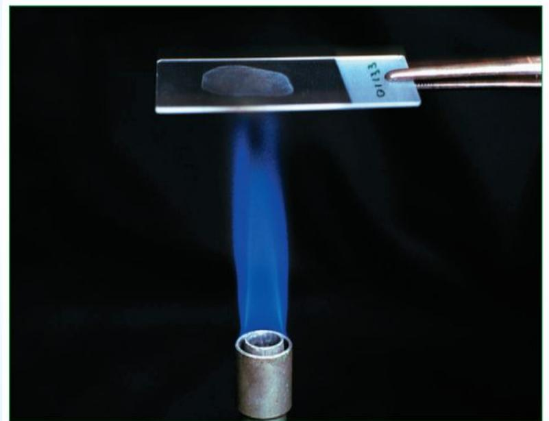
Фиксация мазна над пламенем газовой горелки
