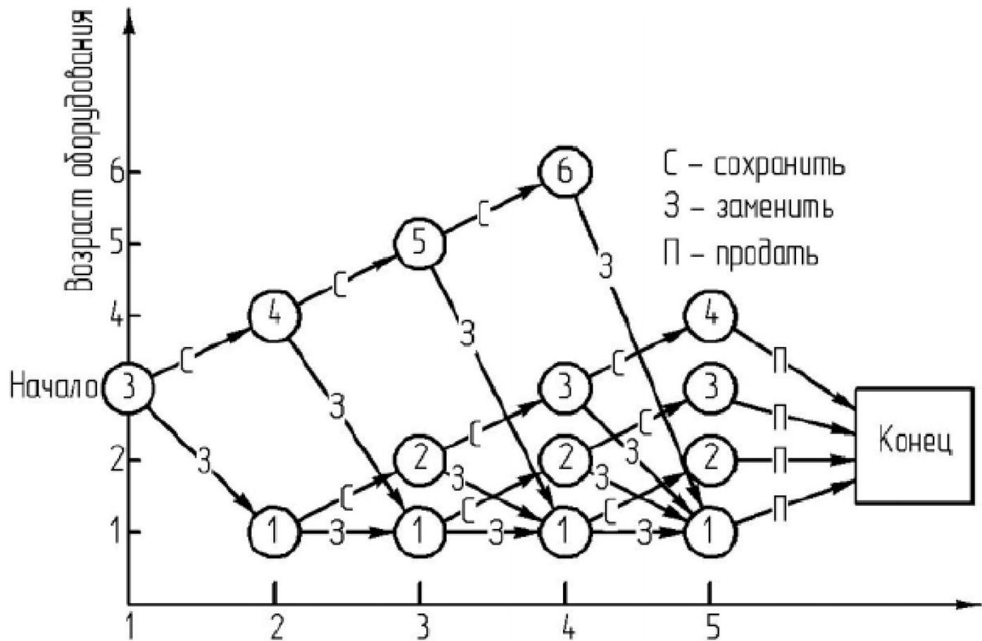
Рисунок 3 – Схема возможной замены механизма
