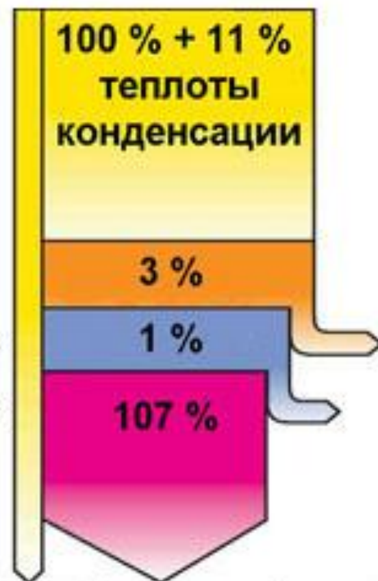
Газовый конденсатный котел
