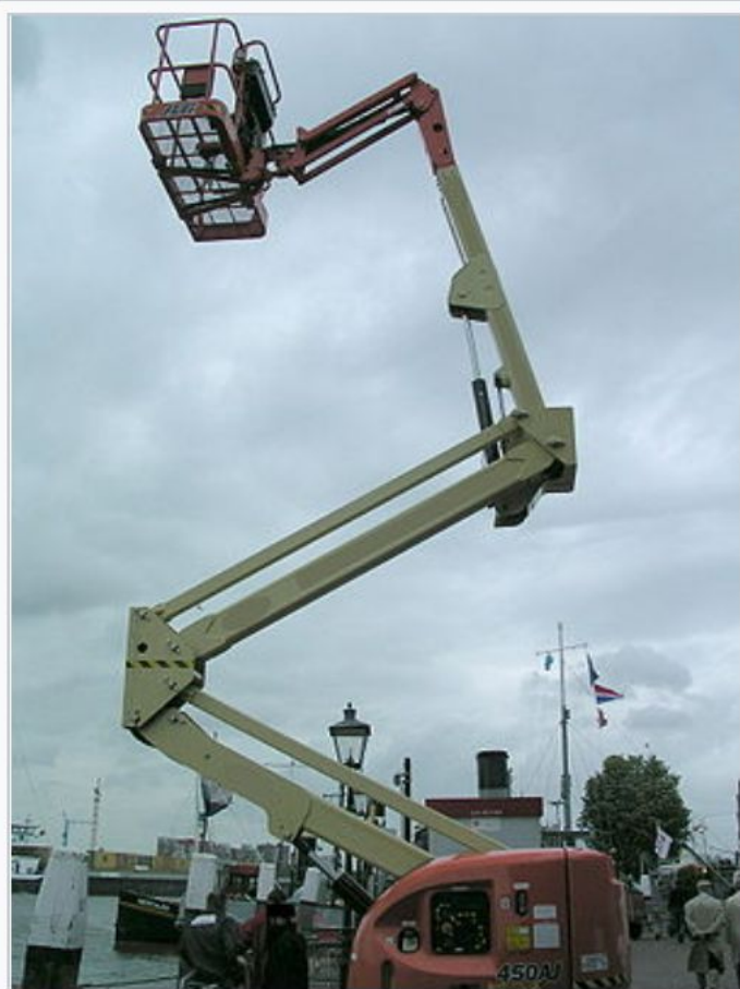
Подъёмник на основе параллелограммных механизмов — хорошо видны два внизу и один вверху
