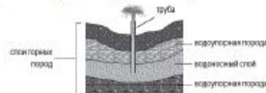
A. Когда люди опускают трубы в слой горных пород, вода течет вверх по трубе и выливается на землю.
