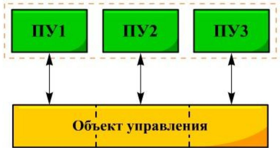
Одноуровневые централизованные системы применяются в основном для управления относительно несложными объектами или объектами, расположенными на небольшой территории.
