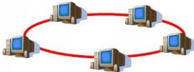
Сигналы передаются по кольцу в одном направлении и проходят через каждый компьютер (замкнутая сеть).
