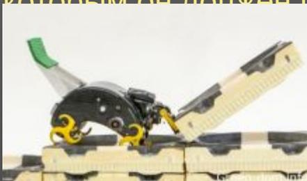
Сенсоры позволяют им видеть кирпичи и соседних роботов, а правила передвижения зависят от конечной структуры, которую необходимо возвести. Например, они не позволяют роботам размещать кирпичи там, где они могут легко обвалиться, или помещать кирпич туда, где он окажется зажат между двумя соседними.
