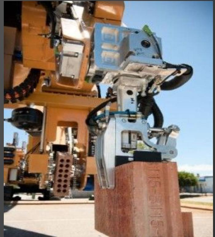
На конце находится клешня, которой робот берет кирпич и складывает в нужной форме и последовательности. Чтобы задать форму дома или строения используется система компьютерного автоматизированного 3D-проектирования. После создания проекта, робот сам рассчитывает, где и как нужно класть кирпич.
