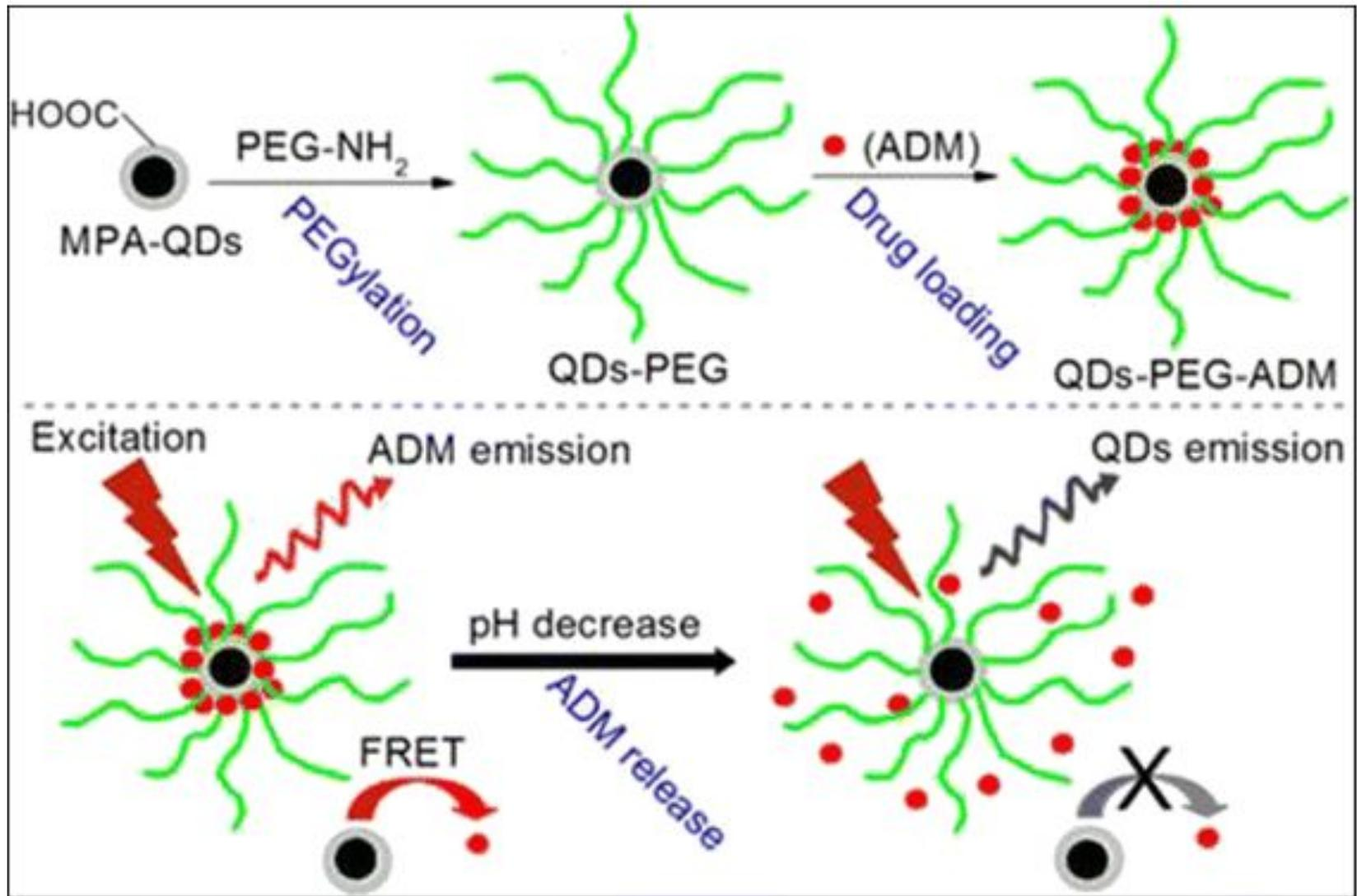
P.S. Действие квантового дота основано на феномене «флюоресцентного резонансного переноса энергии» или FRET. Два хромофора выступают в роли «донора» и «акцептора» энергии возбуждения, при условии пересекающихся значений длин волн и маленького расстояния между ними. При этом эмиссия донора «гасится», а при диссоциации «донора» и «акцптора» – возобновляется.
