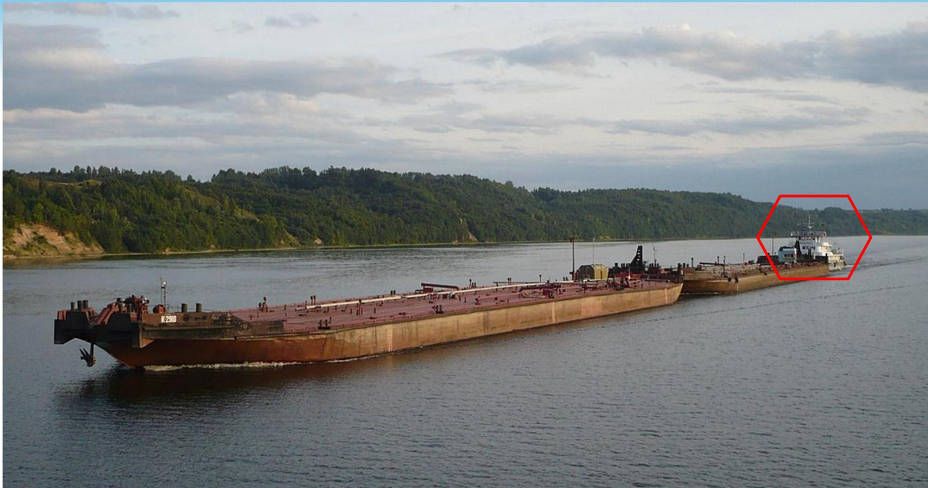
Буксир ведет две баржи. Двухвальная энергетическая установка с двумя винтами в поворотных направляющих насадках обеспечивали толкачу высокие маневренные качества на переднем и заднем ходу.
