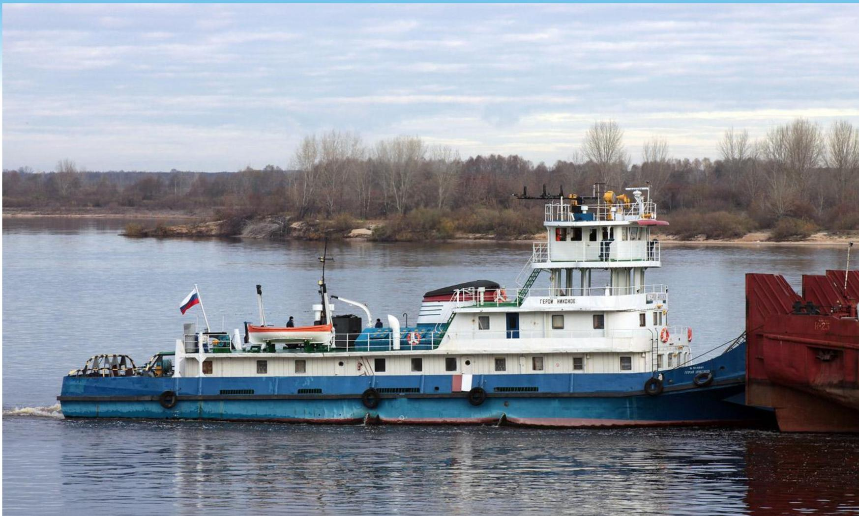
А это – оригинал. В 1957 г. был создан речной буксир нового типа - толкач для вождения тяжелых составов по Волге и Каме с переходом по водохранилищам без ограничений по погоде. Первый крупный буксир-толкач мощностью 1200 л. с. получил название «Зеленодольск».
