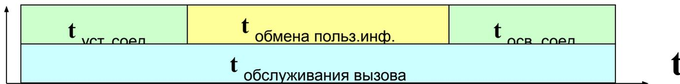
Обмен сигнальной информацией осуществляется только при установлении и освобождении соединения
