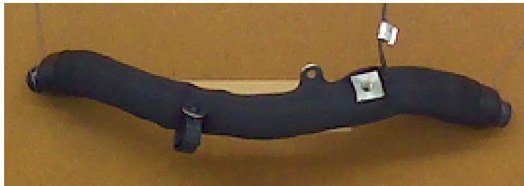
Подогрев трубки PCV (адаптировано для России)
