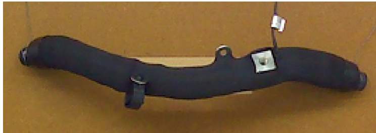
Подогрев трубки PCV (адаптировано для России)
