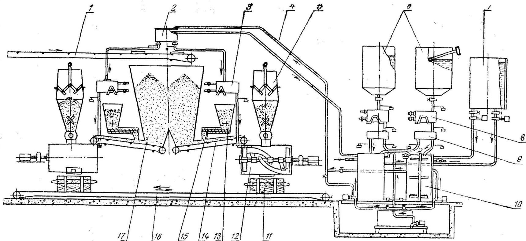
Схема установки лопастного смесителя для приготовления самотвердеющих смесей (ЖСС)
